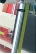
■ Montée et descente de la scie par boîtier à ressort
