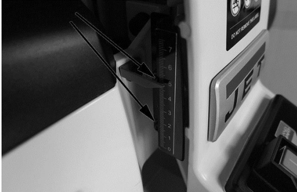
Figure 8-1: Réglage de l'échelle de profondeur
