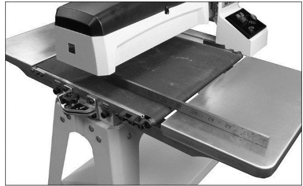
Figure 6-4: Alignement des extensions de table
