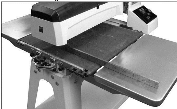
Abb. 6-4: Ausrichten der Verlängerungstische
